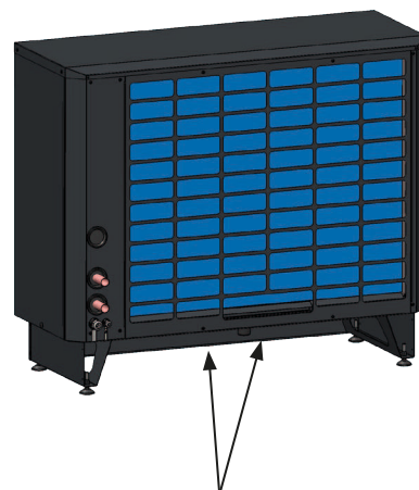
Sběrač kondenzátu a odtok zkondenzované vody
