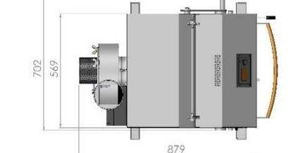
Obrázek 3. Rozměry a odstup od stěny
