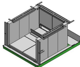
Obrázek 14. Spodní spalovací prostor - vyjmoutá záslepka (45)
