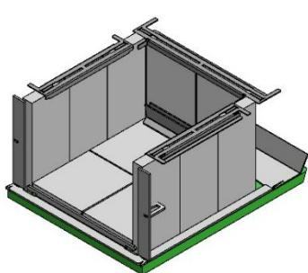
Obrázek 13. Spodní spalovací prostor - instalovaná záslepka (45)
