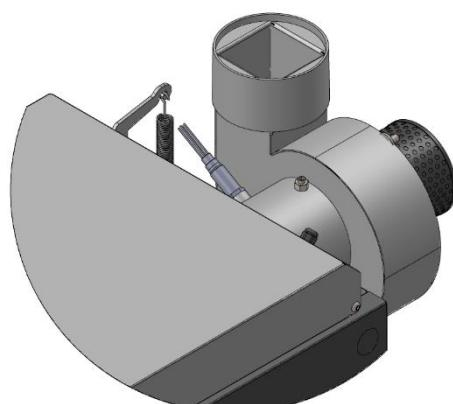
Instalace lambda sondy do odtahového ventilátoru
