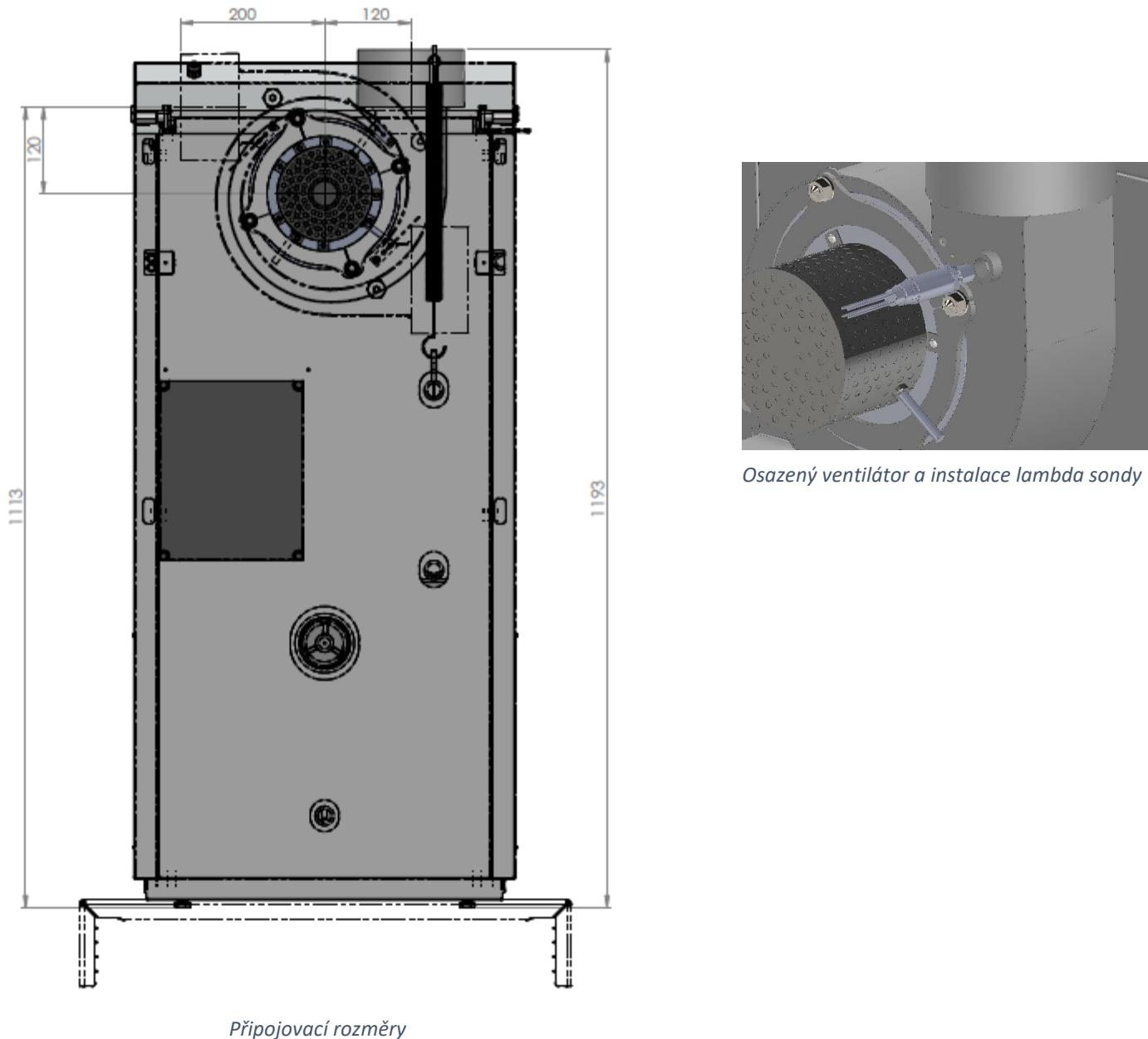
Pro verze kotlů LAMBDA – instalujte do závitu na odtahovém ventilátoru lambda sondu. Následně ji připojte ke kabelu vedoucímu z rozvodnice regulátoru pomocí konektoru.
