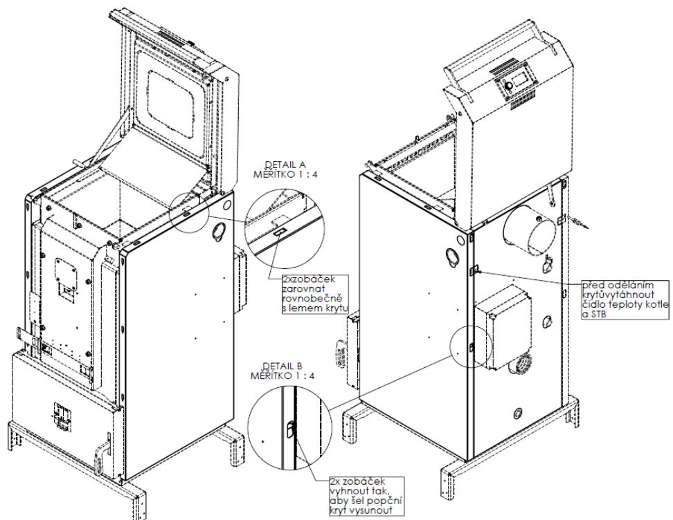
Pro sestavení postupujte opačným způsobem než při odstrojení.
