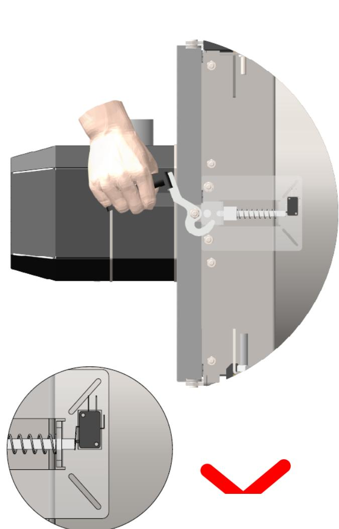
Obrázek 12 Špatné uzavření předních dvířek
