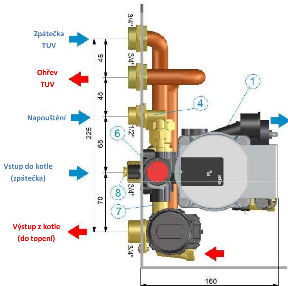
Obrázek 7 Schéma zapojení do čerpadlové skupiny, kde: 1 - čerpadlo, 4 - Napouštěcí nátrubek, 6 - pojíšťovací ventil, 7 - klapka by pass, 8 - vypouštěcí nátrubek
