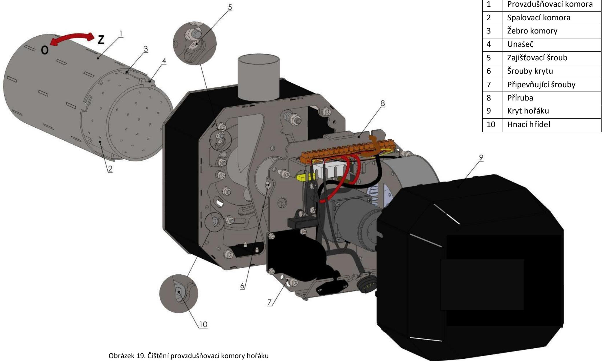
Obrázek 19. Čištění provzdušňovací komory hořáku
