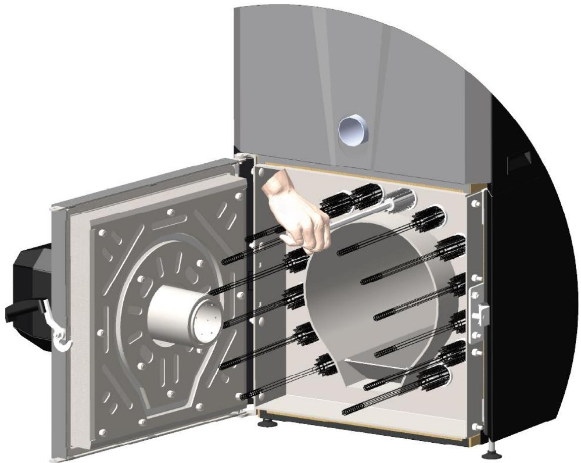
Obrázek 16 Čištění výměníku kotle
