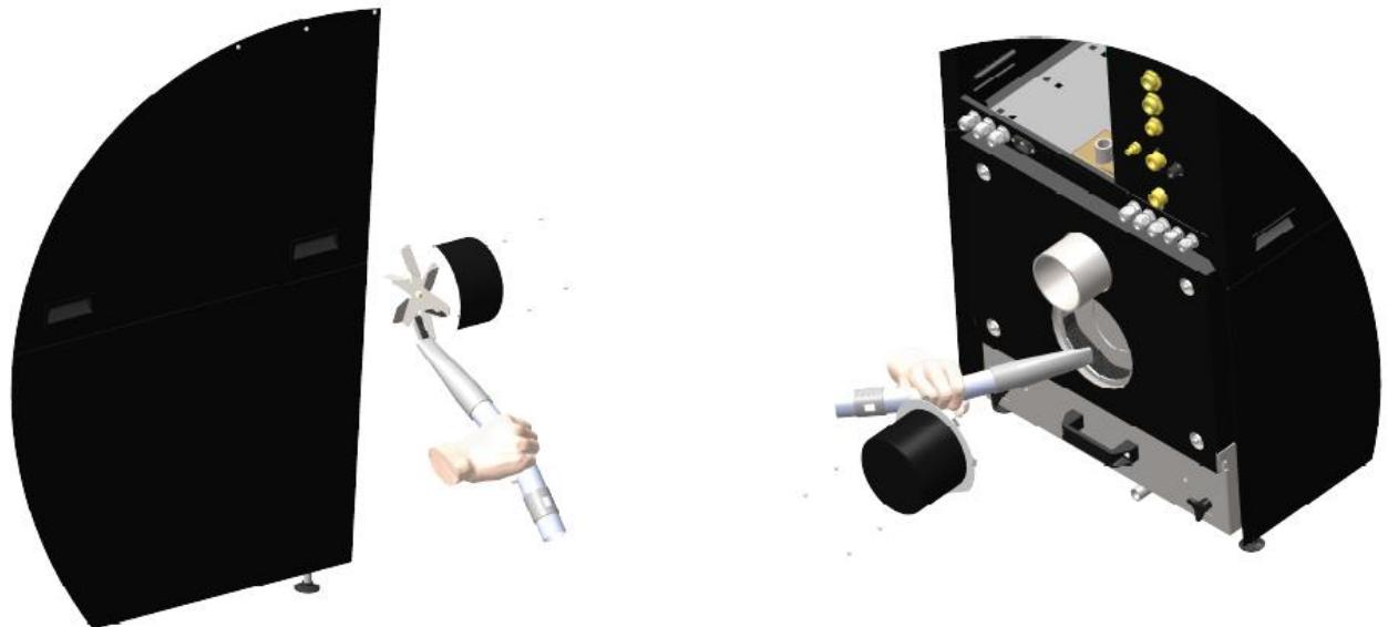
Obrázek 17 Čištění ventilátoru a jeho komory
