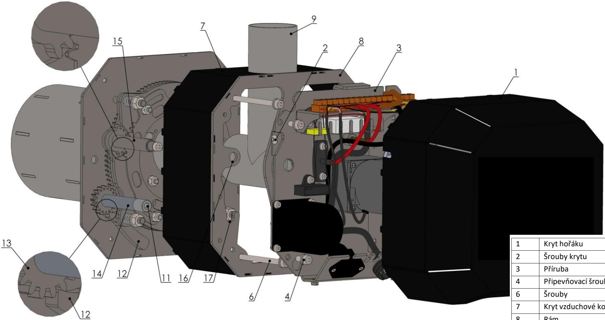
Obrázek 22. Mazaní ložisek rotačního mechanismu
