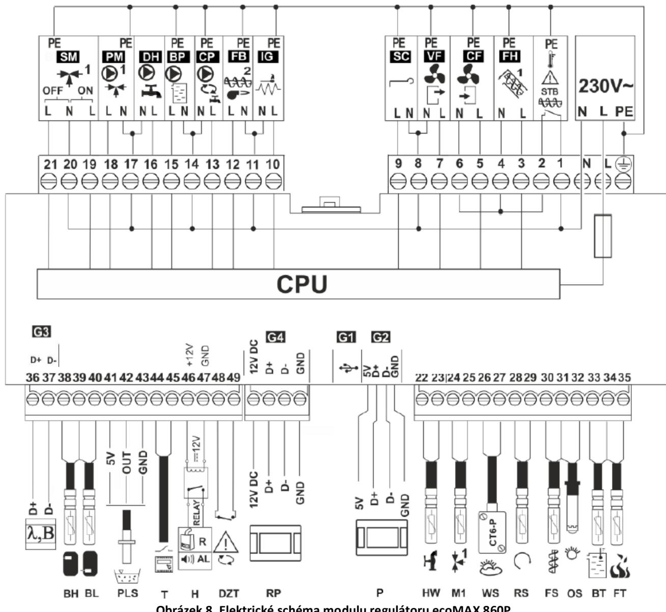
Obrázek 8. Elektrické schéma modulu regulátoru ecoMAX 860P
