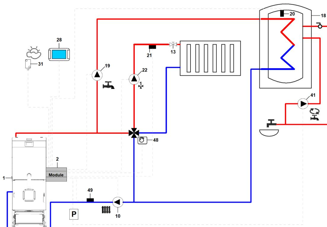
1 – kotel RP Compact, 2 – regulátor, 10 – čerpadlo kotle, 13 – kulový ventil, 18 – zásobník TUV, 20 – čidlo teploty TUV, 21 – čidlo teploty MIX1 (CT4), 22 – čerpadlo MIX1, 28 – ecoSTER, 31 – čidlo venkovní teploty, 41 – cirkulační čerpadlo TUV, 48 – pohon směšovacího ventilu, 49 – čidlo teploty vratné vody
