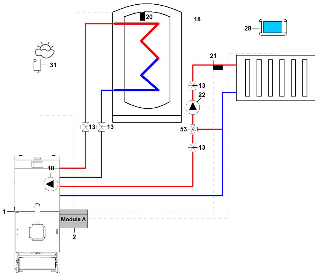
1 – kotel RP Compact, 2- regulátor, 10 – čerpadlo kotle a TUV (integrovaná čerpadlová skupina), 13 – kulový ventil, 21 - čidlo teploty MIX1 (CT4),22 - čerpadlo MIXu 1, 28 – ecoSTER, 31 – čidlo venkovní teploty (CT6-P),
